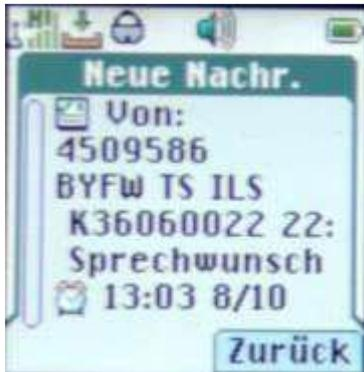
Mit Annahme des Sprechwunsches durch den Disponenten wird folgende Meldung am Funkgerätdisplay angezeigt: (= „J“ bzw. Sprechaufforderung). Ferner ist zeitgleich ein „Piepton“ am Funkgerät zu hören:
